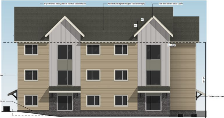
Bldg. A Back Elevation
